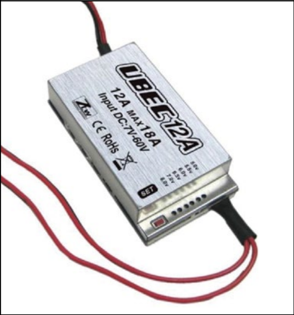
В БПЛА применяют аккумуляторные батареи разного напряжения и разной емкости. Напряжение на батарее изменяется в зависимости от нагрузки на батарею и остаток заряда. Сложная электроника (автопилот, модуль телеметрии, GPS) не имеет встроенного стабилизатора или преобразователя питания. Чтобы подпитать электронику от тяговой батареи и не использовать дополнительную АКБ, предназначенную только для питания электроники, применяют преобразователь/стабилизатор или ВЕС (UBEC). Различаются они по мощности, напряжению на выходе и принципу работы.
