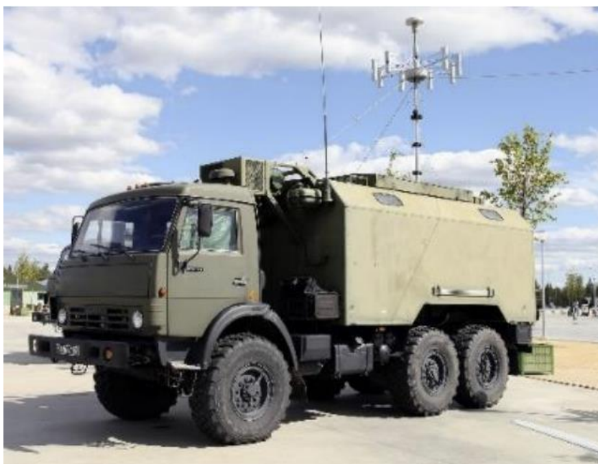
Рис. 5 – Комплекс Р-330Ж «Житель», станция РЭБ и РЭР.
