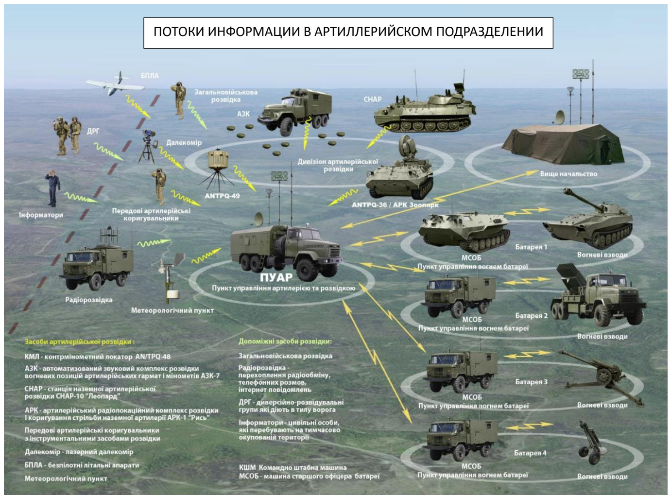
Рис.3 - Схема потоків інформації в рамках артилерійського подразделения уровня БрАГ. Различные типы разведывательной информации анализируются и обрабатываются с целью постановки огневых задач на поражение целей.
